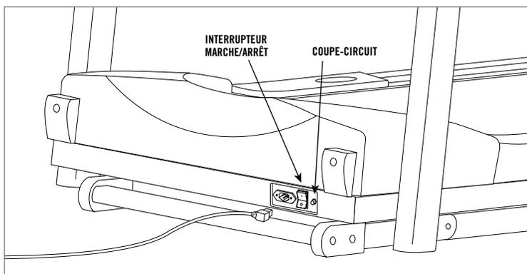
Connecter la fiche d'alimentation au tapis roulant et connecter le cordon d'alimentation à une prise. L'interrupteur est situé près du cordon d'alimentation. Mettre l'interrupteur sur ON (marche) afin que l'interrupteur s'allume. Un bip retentit et la console s'allume.
