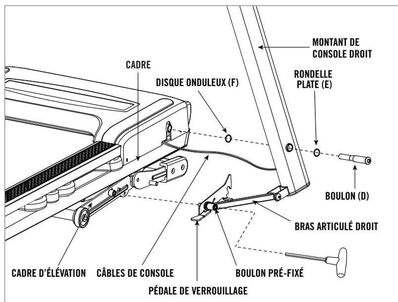
**A** Passer le **FIL DE GUIDAGE** dans le **MONTANT DE CONSOLE DROIT**. Cela fait, le bout des **CÂBLES DE LA CONSOLE** doit se trouver en haut du montant. Détacher le **FIL DE GUIDAGE** et le mettre au rebut.
