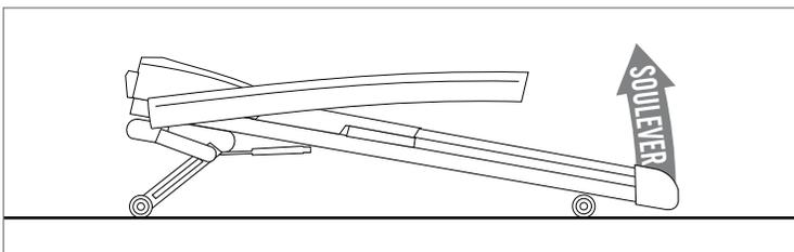
**PROBLÈME :** Les bandes de cerclage ont été retirées avant que l'**ÉTAPE 1 D'ASSEMBLAGE** ne soit terminée et la machine s'est ouverte et ne peut pas être assemblée.
