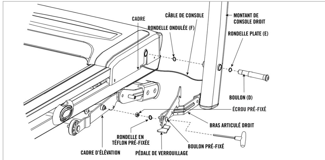
**A** Insérer 1 **BOULON (D)** et 1 **RONDELLE PLATE (E)** dans le **MONTANT DE CONSOLE DROIT** puis 1 **RONDELLE ONDULÉE (F)** et fixer le montant au **CADRE**.
