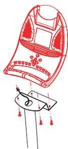
**REMARQUE :** On recommande d'appliquer de la graisse sur les filets de chaque boulon à mesure que l'on monte le produit afin de les empêcher de se desserrer et d'empêcher le bruit. À chaque étape du montage, s'assurer que TOUS les écrous et les boulons sont bien en place et partiellement vissés avant de commencer à serrer complètement le PREMIER boulon.
