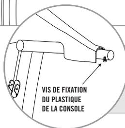
On peut devoir desserrer la **VIS DE FIXATION DU PLASTIQUE DE LA CONSOLE** pour pouvoir glisser la **RALLONGE DE GUIDON** sous le plastique de la console (voir l'étape B).
