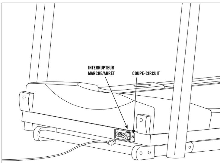
Connecter la fiche d'alimentation au tapis roulant et connecter le cordon d'alimentation à une prise. L'interrupteur est situé près du cordon d'alimentation. Mettre l'interrupteur sur **ON** (marche) afin que l'interrupteur s'allume. Un bip retentit et la console s'allume.
