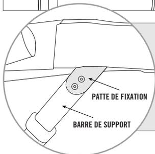
**Remarque :** À l'ÉTAPE C, la patte de fixation doit être à l'extérieur de la barre de support (voir la figure de gauche).
